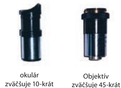
Obr. 7 Hlavné časti mikroskopu
